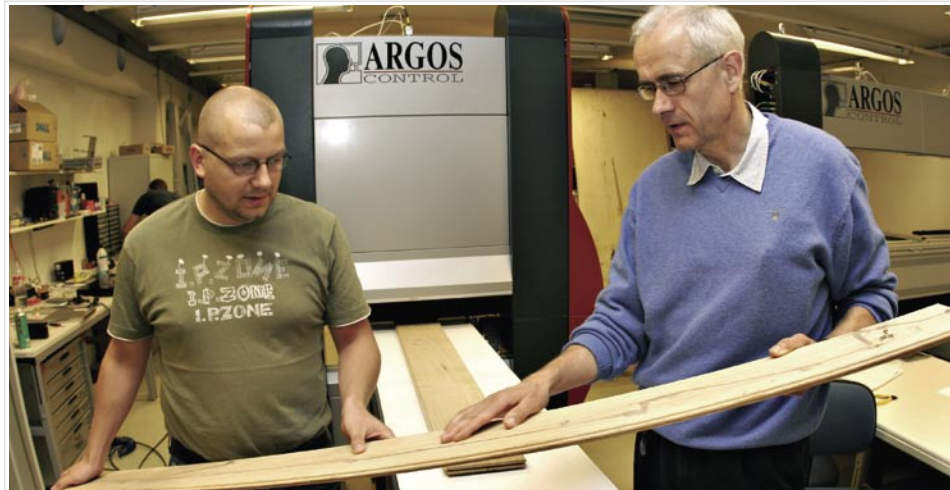
Sigmund Sundfør (til høyre) og Håkon Bergli i Argos Control studerer en planke som er sparklet etter den automatiske kvalitetskontrollen.
